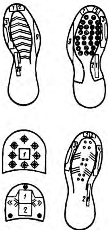
Рисунок 1 – Схема вырубki образцов по ГОСТ 7926-75
