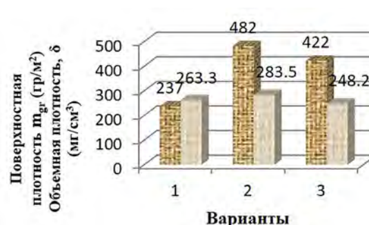
Рисунок 3 – Диаграмма изменения показателей: поверхностная плотность, объемная плотность
