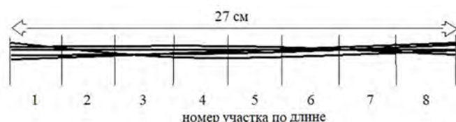
Рисунок 1 – Схема формирования отрезков у анализируемой навески волокна
