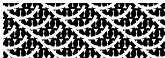
Рисунок 3 – Схема структуры одинарного кулирного трикотажа футерованного переплетения
