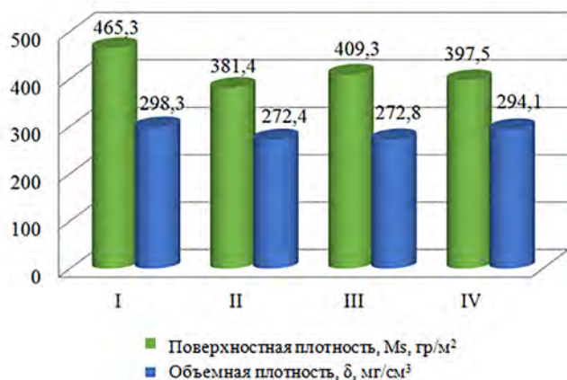
Рисунок 1 – Гистограмма изменения поверхностной и объемной плотности новой структуры рисунчатого трикотажа
