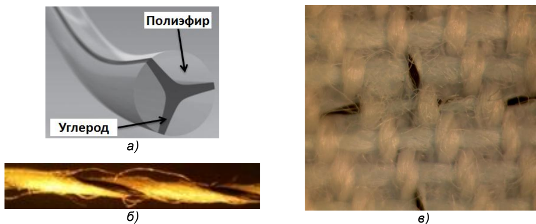
Рисунок 1 – Элементарная нить Nega-Stat® P210 (а), антистатическая комбинированная нить 25,8 текс (б), лицевая сторона разработанной ткани (в)
