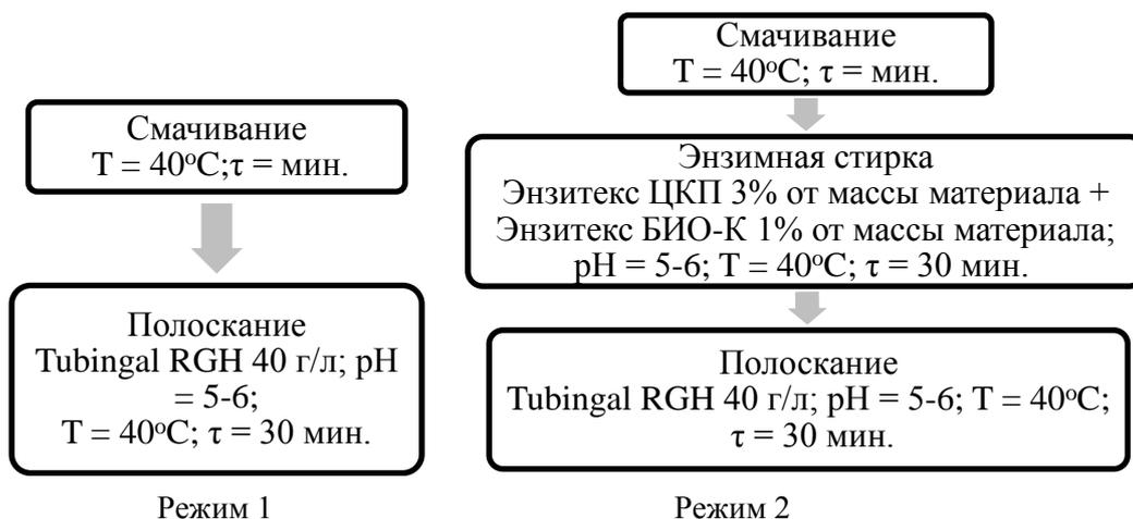
Рисунок 1 – Технологические режимы умягчения хлопчатобумажных махровых изделий
