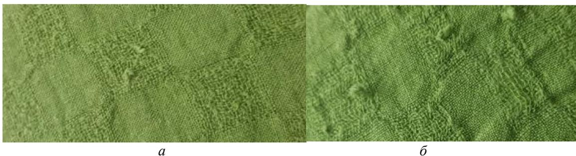
Рисунок 2 – Фото льняных и конопляных тканей после 2000 циклов:
