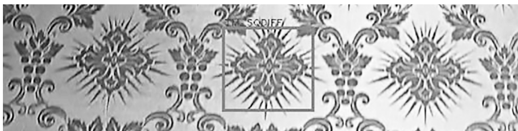
Рисунок 5 – Результат обработки изображения методом TM_SQDIFF
