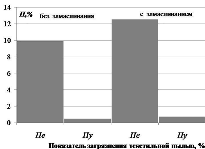
Рисунок 3 – Влияние замамливания ткани «Грета» арт. 4С5-КВСН с ВО на ее пылеемкость и пылеудержание
