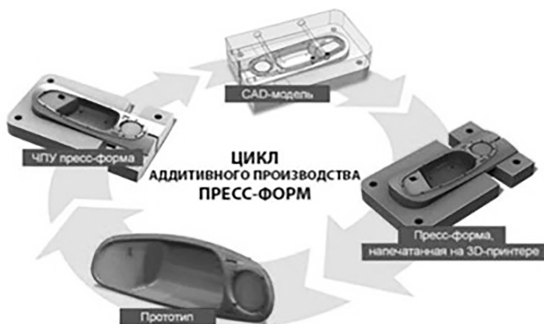
Рисунок 2 – Цикл аддитивного производства пресс-форм
