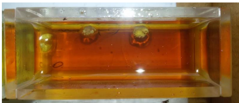
Рисунок 2 – Пример набухания СБС-полимеров линейного строения в ЛТМ
