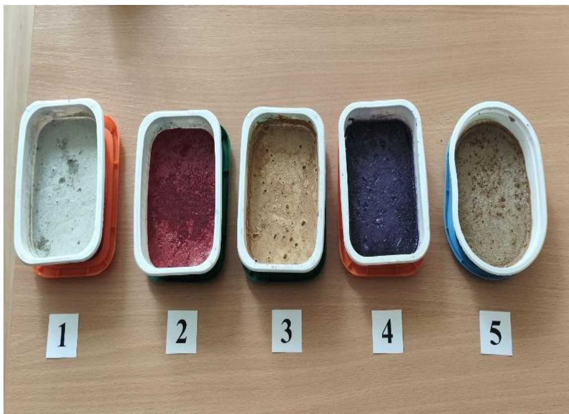
Рисунок 1 – Готовые образцы цементного раствора с применением натуральных красителей: № 1 – контрольный образец без красителя; № 2 – краситель – смесь для окрашивания пищевых продуктов (Алая), состав: краситель пищевой (Е129), загустители (глицерин, камедь гуаровая, камедь рожкового дерева), краситель кармин; № 3 – краситель – куркума, род многолетних травянистых растений семейства имбирных (краситель куркумин (индийский шафран)); № 4 – краситель для ткани «Индиго» – синий, состав: 30 % краситель органический; 30 % затвердитель; 40 % связующее и наполнитель; № 5 – краситель – отходы химводоподготовки (железосодержащие).
