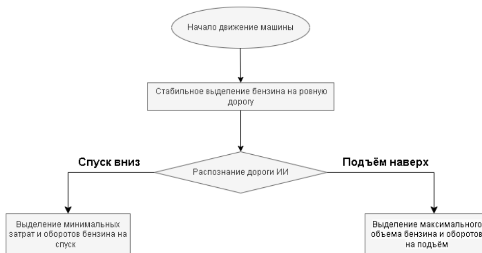
Рисунок 2 – Трата бензина при движении машины на особом типе дороги
