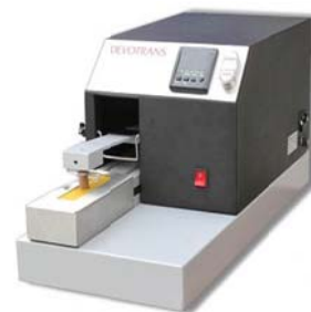
Рисунок 4 – Кромметр для определения устойчивости окраски к трению DVTCRMM
