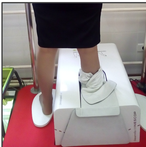
Рисунок 2 – Процесс сканирования на стационарном ортопедическом сканере Inescop
