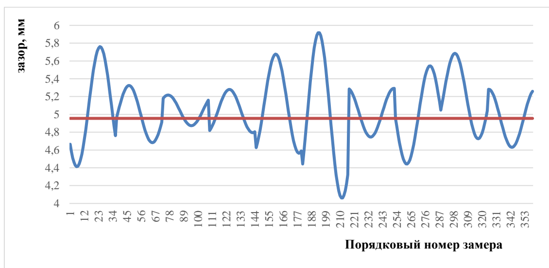
Рисунок 5 – Зазор для детали диаметром 29,73 мм
