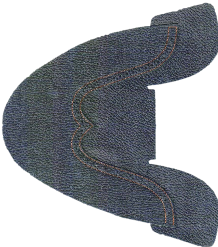
Рисунок 3 – Заготовка, собранная на полуавтомате ПШ-1
