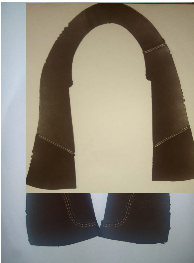
Рисунок 3 – Заготовка, собранная на полуавтомате ПШ-1
