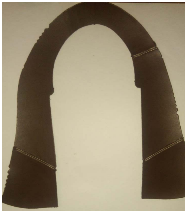
Рисунок 3 – Заготовка, собранная на полуавтомате ПШ-1
