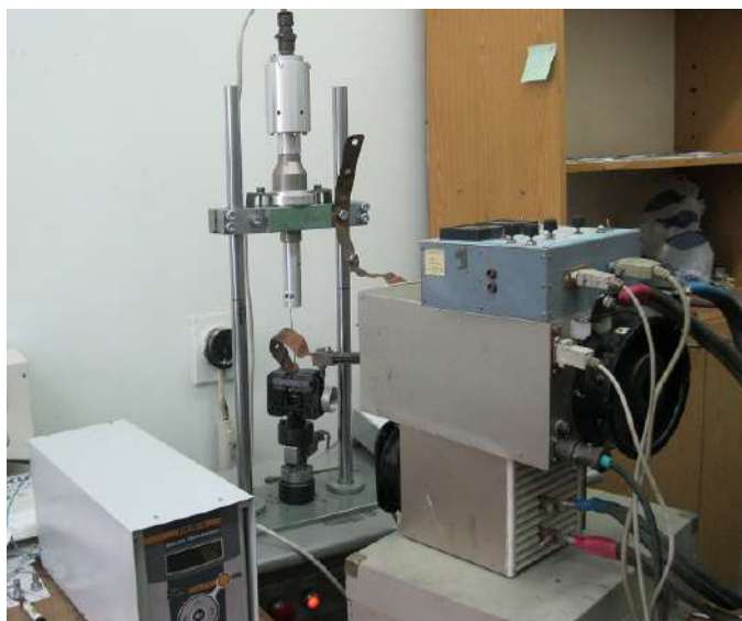
Рисунок 1 - Экспериментальная установка для совместного воздействия на проволоку импульсного тока и ультразвуковых колебаний при растяжении
