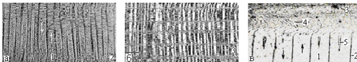
Рисунок 1- Магнитная доменная структура ЭТС до (а), после (б) ЛЛО и в зоне (в) ЛО. 1– 180^\circ полосовые домены; 2–граница между доменами; 3–зона ЛО и измельченные домены;
