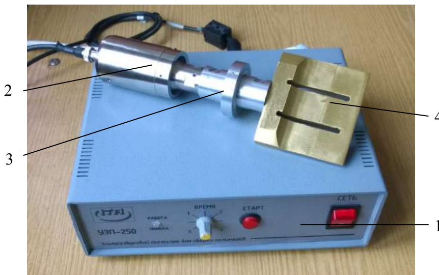
Рисунок 1 - Ультразвуковая система реза: 1- электронный генератор, 2 – пьезоэлектрический преобразователь, 3 – бустер, 4 – ультразвуковой нож
