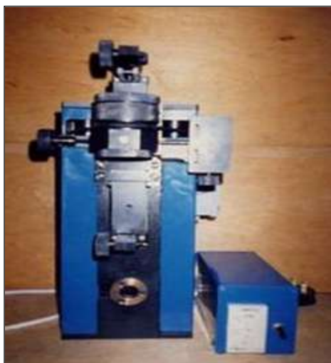
Рисунок 1 - Ультразвуковой станок для доводки волок (генератор УЗК не показан)
