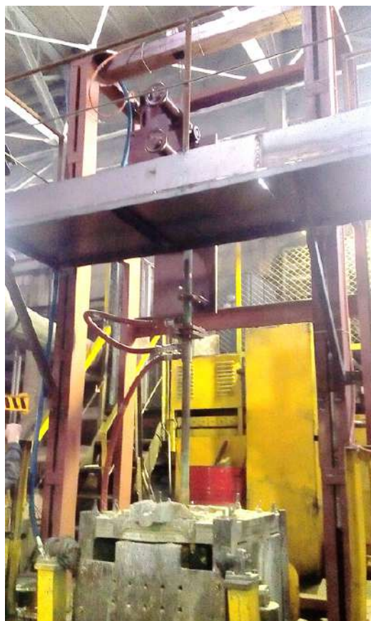
Рисунок 2 - Установка непрерывного литья вверх на КУЗОЦМ
