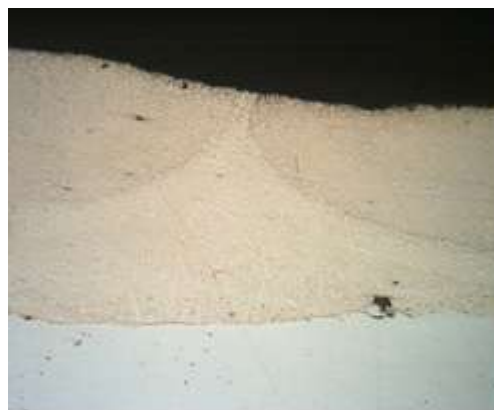
Рисунок 2- Поперечное сечение мультимодального полосчатого покрытия x50
