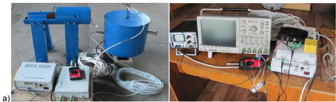
а) ускоритель частиц с камерой, б) приборы для регистрации и измерений ЭМИ Рисунок 1- Экспериментальная установка регистрации импульсов электромагнитного излучения
