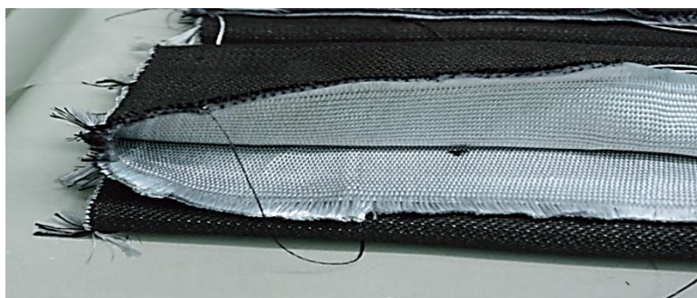
Рисунок 2 – Тканая заготовка из углеродных и кварцевых нитей
