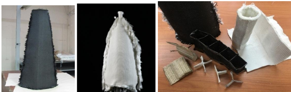
Рисунок 1 – Цельнотканые многослойные заготовки и тканые преформы
