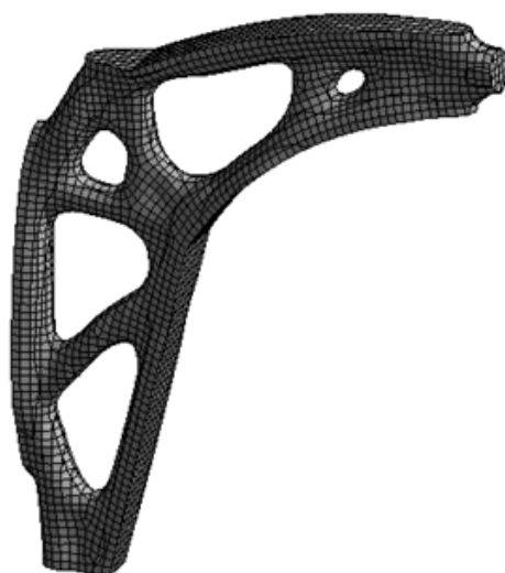
Рисунок 2 – Форма рычага, полученная в результате оптимизации
