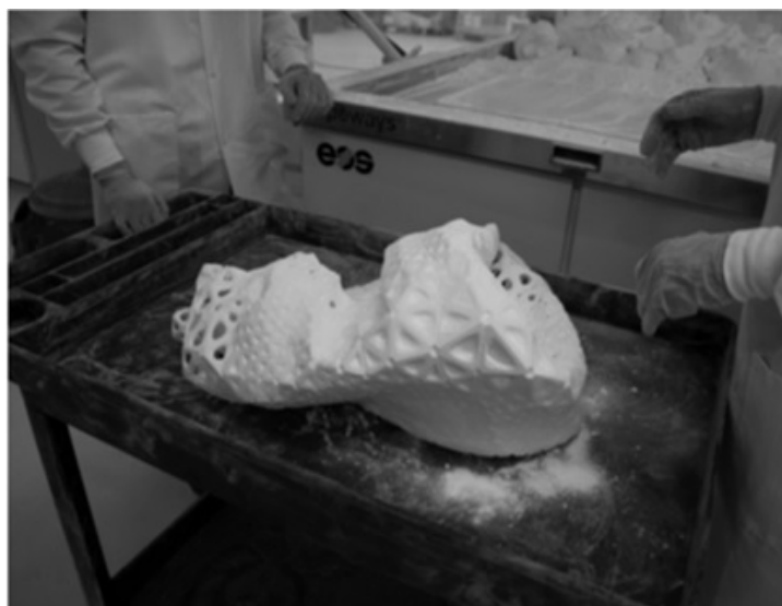
Рисунок 1 – Этап производства Kinematic Dress с помощью SLS технологии 3D-печати
