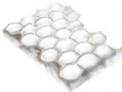
Рисунок 2 – Схема скрепления нетканого материала при использовании технологии термического укрепления его структуры
