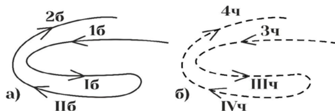
Рисунок 2 – Последовательность прокладывания утков для ткани двойной ширины:
