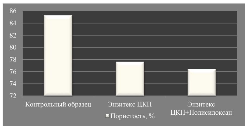
Рисунок 3 – Оценка пористости льносодержащих маховых изделий
