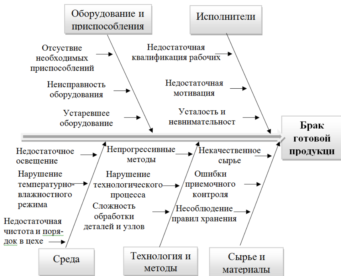
Рисунок 2 – Причинно-следственная диаграмма возникновения дефектов и нарушения технологического процесса
