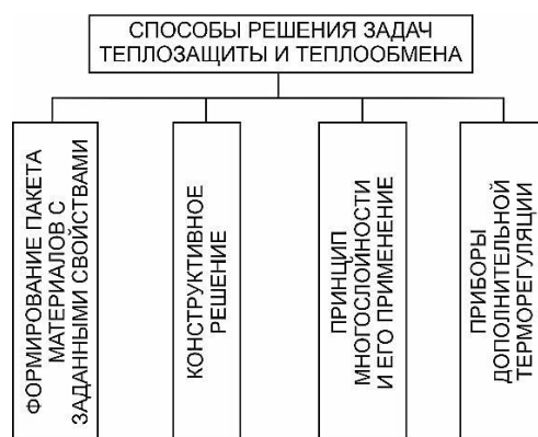
Рисунок 2 – Основные способы решения задач теплообмена и теплозащиты
