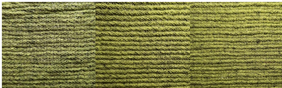
Рисунок 3 – Внешний вид ткани: а – простое «Пике», б – сложное «Пике», в – ткань с чередованием элементов простого и сложного «Пике»
