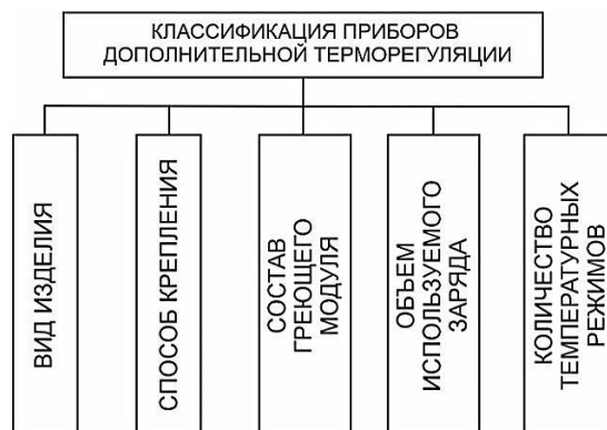
Рисунок 4 – Классификация приборов дополнительной терморегуляции
