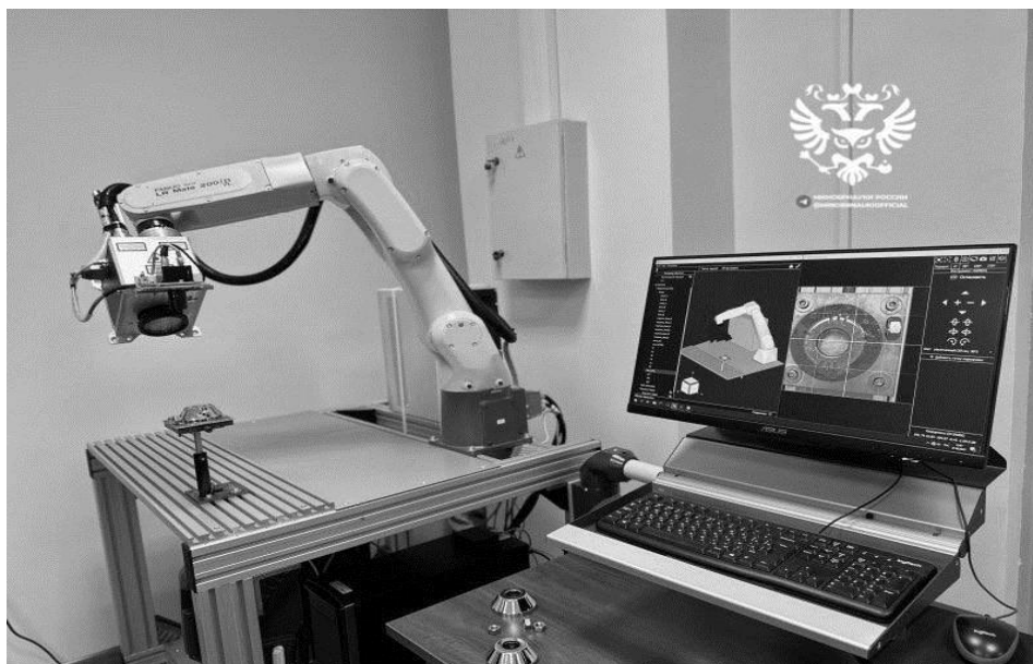
Рисунок 1 – Пример применения информационных технологий в практическом обучении (в ИТМО разработали универсальный роботизированный лазерный комплекс для обучения обработке медицинских имплантатов)
