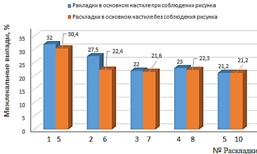
Рисунок 4 – Процент межлекальных выпадков в раскладках при различных вариантах сочетаний
