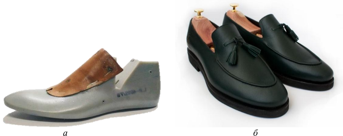
Рисунок 2 – Откорректированная с учетом субъективных ощущений комфортности потребителя колодка (а), и модель мужских полуботинок «лоферы» (б)
