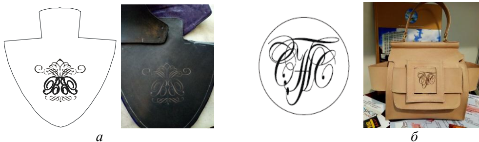
Рисунок 1 – Разработка элементов графического дизайна для лазерной гравировки: а – союзка, б – клапан сумки
