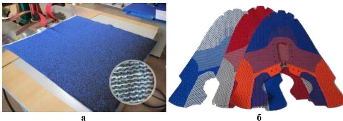
**Рис. 2. а – Готовое полотно; б – Заготовка верха обуви после лазерной обрезки [5]**
