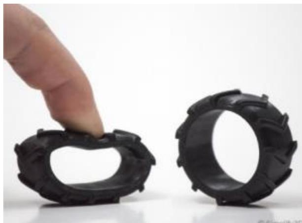
Рис.1. Свойства пластика flex [2]
