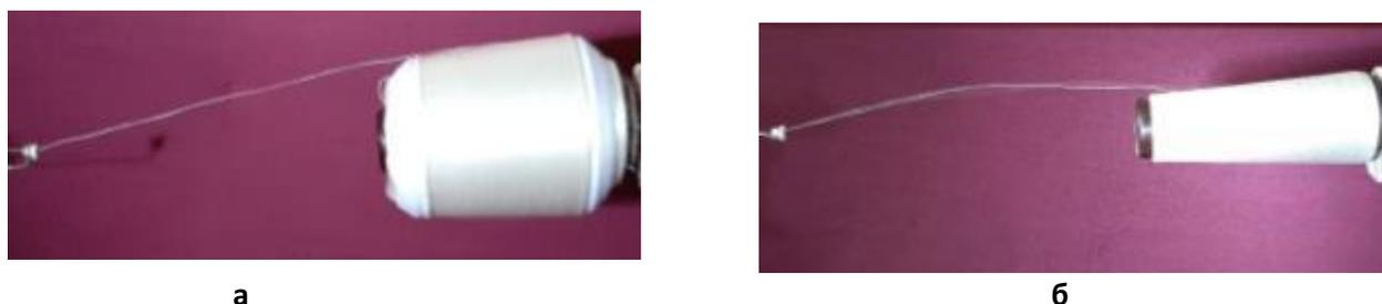
**Рис. 2. Формы баллонов шёлковой нити при скорости сматывания 200 м/мин**
