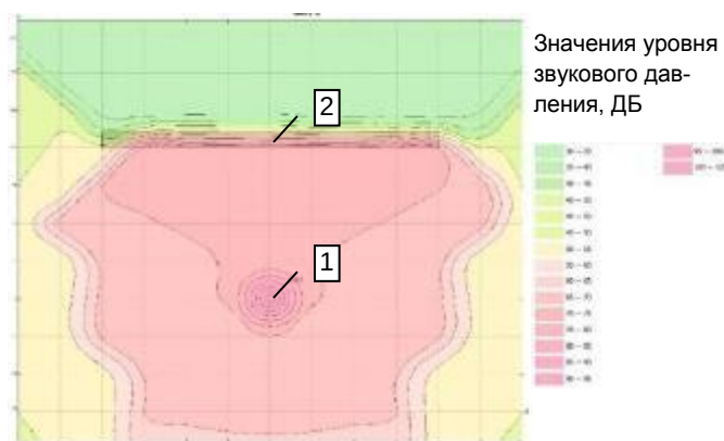
Рис. 3. Акустическое поле в октавной полосе 500 Гц: 1 – источник шума, 2 – звукопоглощающая преграда
